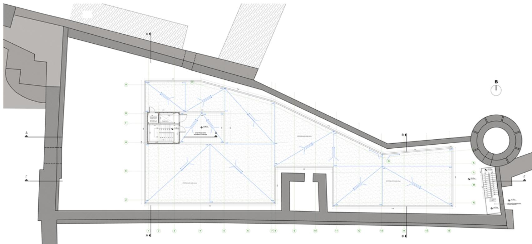
Εικόνα 14: : Κάτοψη δώματος όπου απεικονίζεται η διάστρωση του σκυροδέματος κατά τρόπο κατάλληλο για τη διαμόρφωση ρύσεων.
