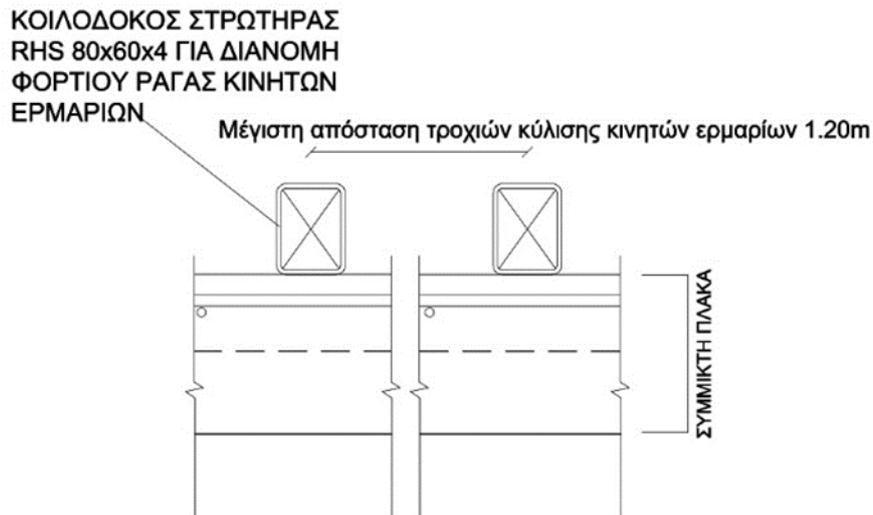
Εικόνα 12: Λεπτομέρεια στρωτήρα κοιλοδοκού στη σύμμικτη πλάκα σε σημεία τοποθέτησης κινητών ερμαρίων.
